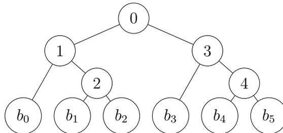
Abb. 5: Voller Binärbaum mit fünf inneren Knoten (0-4) und sechs Blättern  $(b_0, b_1, \dots, b_5)$ .
